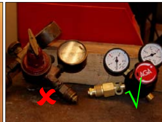
Byt ut gamla förstörda regulatorer mot nya.
