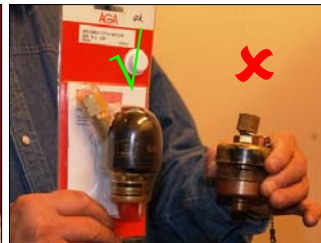
Byt ut de bakslagsskydd som inte klarat trycktestet.
