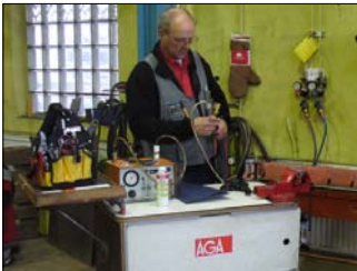
Ventiler testas genom bakåtströmning.
