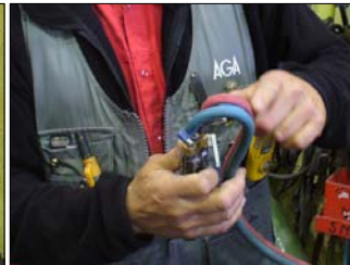
Slangarna inspekteras för slitage eller skada.
