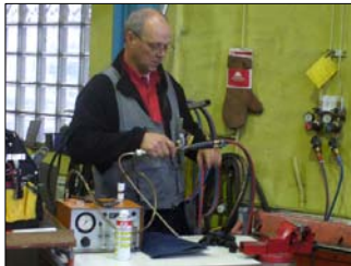
Ventiler testas genom bakåtströmning.
