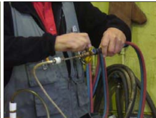
Ventiler testas genom bakåtströmning.
